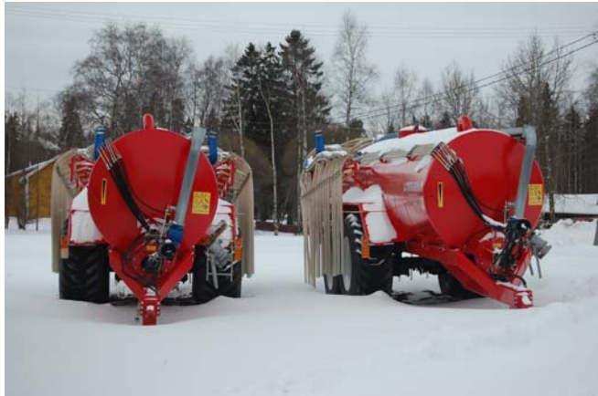
Store dimensjoner på utstyret. To 16,5 tonns vogner med slepeslanger til utkjøring av møkkra.
